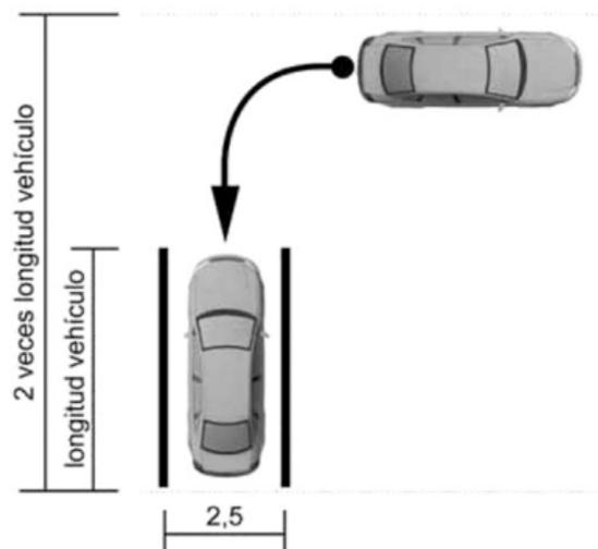
Maniobra K) Estacionamiento seguro para cargar o descargar en una rampa o plataforma de carga o instalación similar
