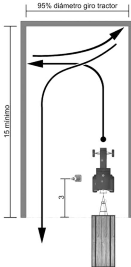
Maniobra I) Estacionamiento y salida del espacio ocupado al estacionar (en línea, oblicuo o perpendicular), utilizando las marchas hacia delante y hacia atrás, en llano o en pendiente ascendente o descendente
